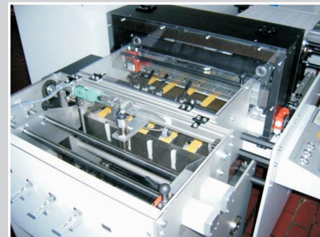
Das **ecojet** Digitaldrucksystem basiert auf dem Single Pass Inkjet Prinzip.
